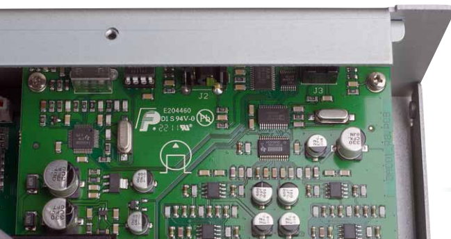
Ein 1792 von Burr-Brown wandelt die digitalen Signale. Zweifelsohne eine einwandfreie Lösung
