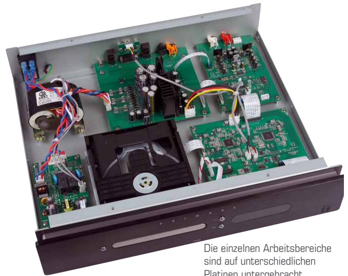
Das intelligente Schaltnetzteil ist eine der Kernkomponenten und sorgt für hohe Laststabilität
